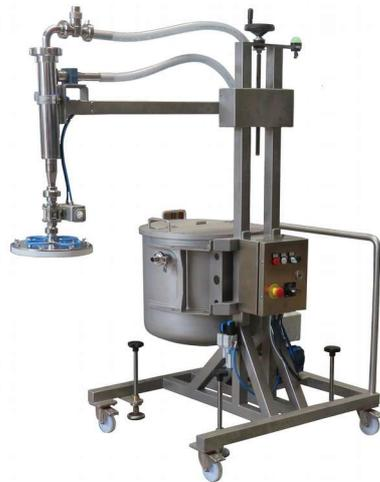
La dosatrice per liquidi alimentari è integrabile alla linea di processo, e viene gestita con il software che la sincronizza con l'avanzamento ed il passo del nastro.
